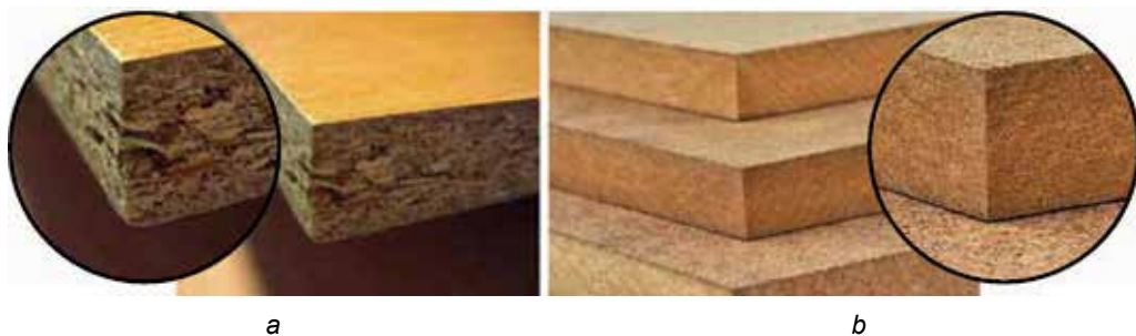
22. ábra. Bútorlapok: a – DSZP; b – MDF
