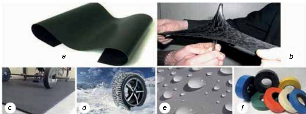
10. ábra. A gumi tulajdonságai: a – rugalmasság; b – nyújthatóság; c – ütésállóság; d – kopásállóság; e – vízállóság; f – elektromos szigetelőképesség
