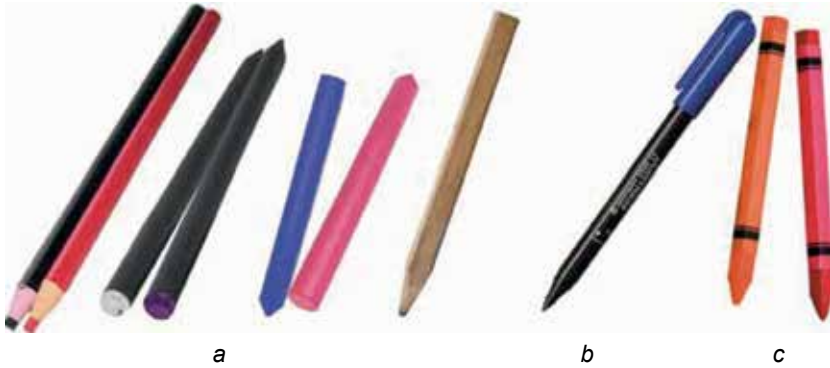
37. ábra. Jelölések felvitelére szolgáló eszközök: a – speciális ceruzák; b – marker; c – viaszkréta
