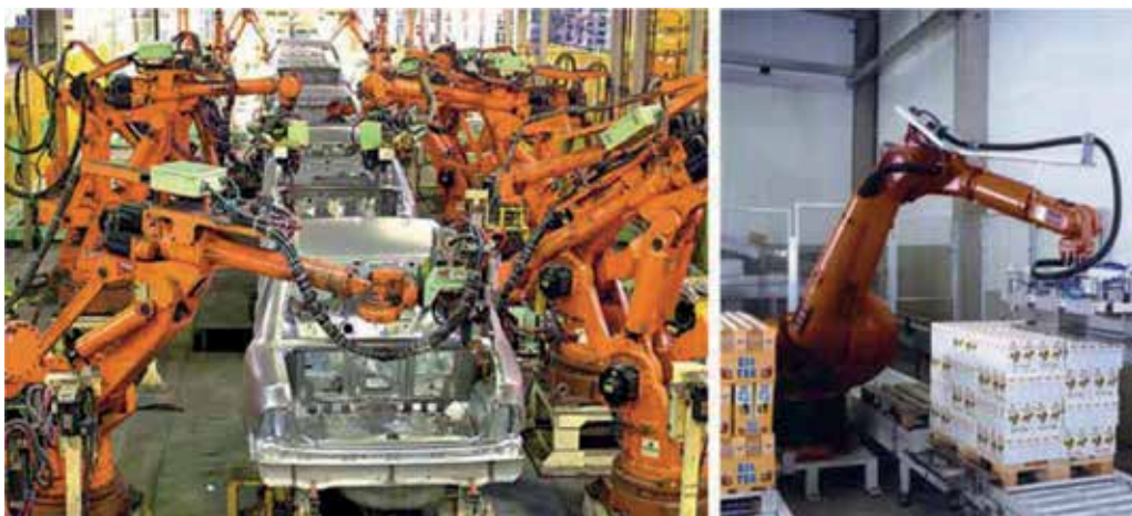
88. ábra. Automatikus gyártósor robotok alkalmazásával: a – gépgyártásban; b – élelmiszeriparban
