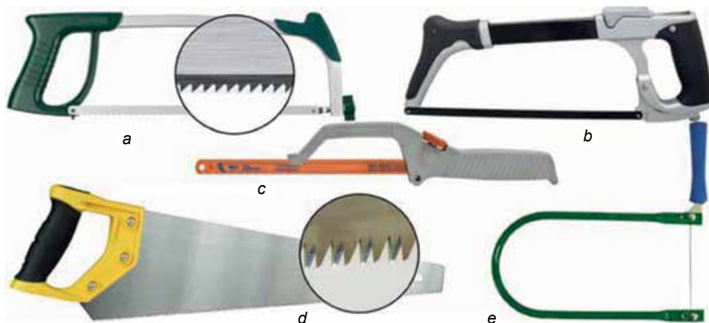
42. ábra. Kézi fűrészek: fém vágásához (a – egyszerű; b – széthúzható; c – fűrészlap); fa vágásához (d – asztalos aprófogú; e – szűrőfűrész)
