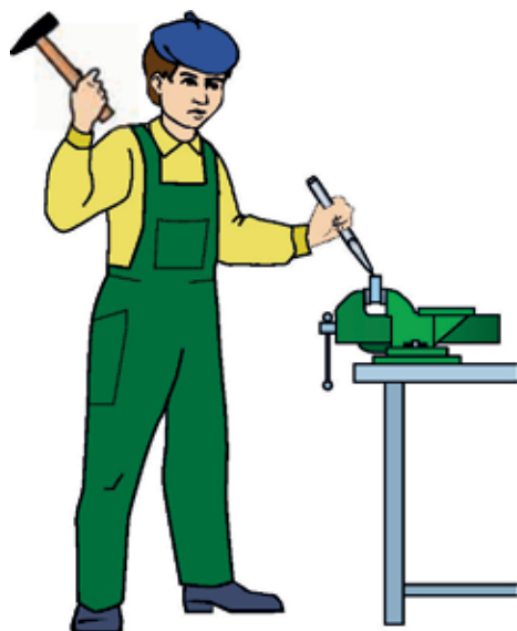
65. ábra. Lábak helyzete fém vésése közben
