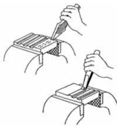
62. ábra. Kanálvésők és horonyvésők: a – kanálvésők; b – horonyvésők; c – munkavégzés kanálvésővel
