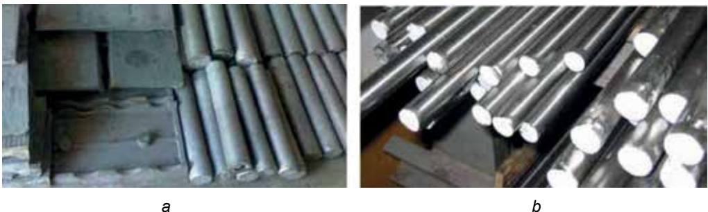
12. ábra. Ötvözetek: a – öntöttvas; b – acél
