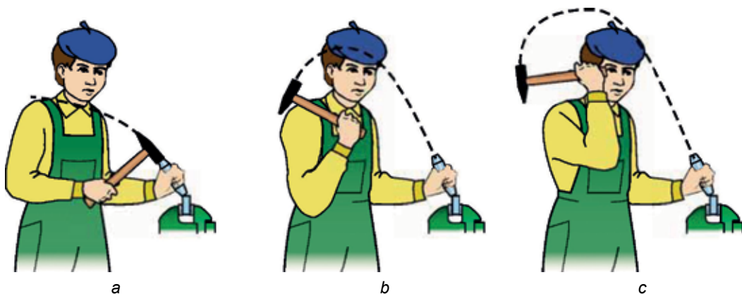
68. ábra. Kalapács mozgáspályája: a – csuklóból végzett ütésnél; b – könyökből végzett ütésnél; c – vállból végzett ütésnél
