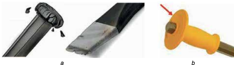
72. ábra. Szétvert, deformált fejű, csorbult pengéjű (a) vágószerszám; védő gumikorong (b)
