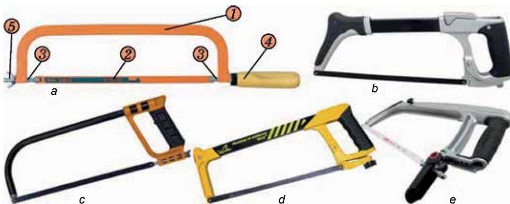
50. ábra. Fémfűrészek: a – szilárd keretű; b – állítható keretű; c – fűrészlapot vízszintes megfeszítő; d – függőlegesen megfeszítésű; e – oldalfeszítésű
