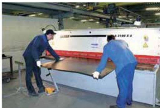
71. ábra. Fém vágása hidraulikus géppel
