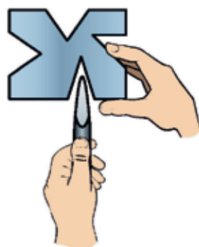
61. ábra. Penge élezési szögének ellenőrzésére szolgáló sablon
