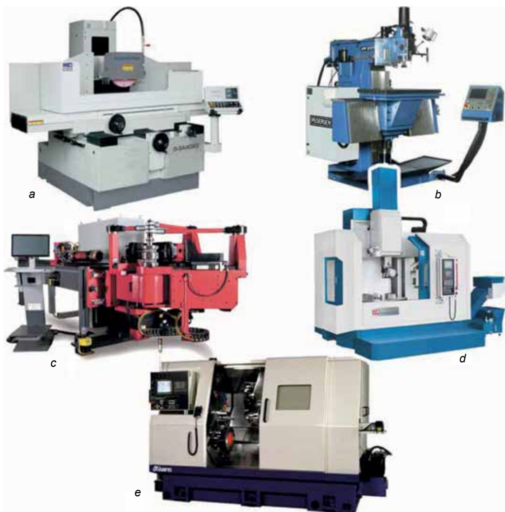
132. ábra. CNC fémmegmunkáló szerszámgépek: a – felületcsiszoló; b – maró; c – csőhajlító; d – függőleges eszterga; e – több tengelyes megmunkálóközpont
