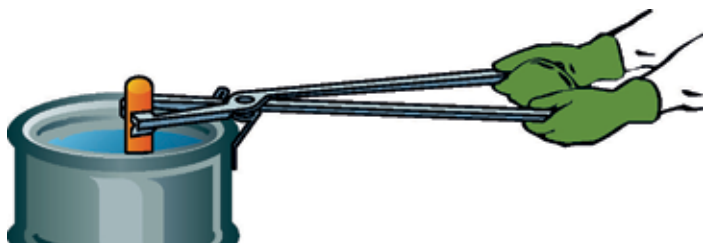
16. ábra. Alkatrész hűtésének módja folyadékban
