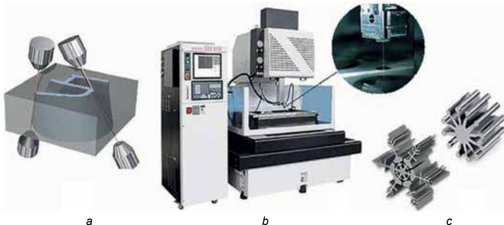
135. ábra. Elektroeróziós megmunkálás: a – vázlat; b – elektroeróziós vágógép, c – elektroeróziós megmunkálás végterméke
