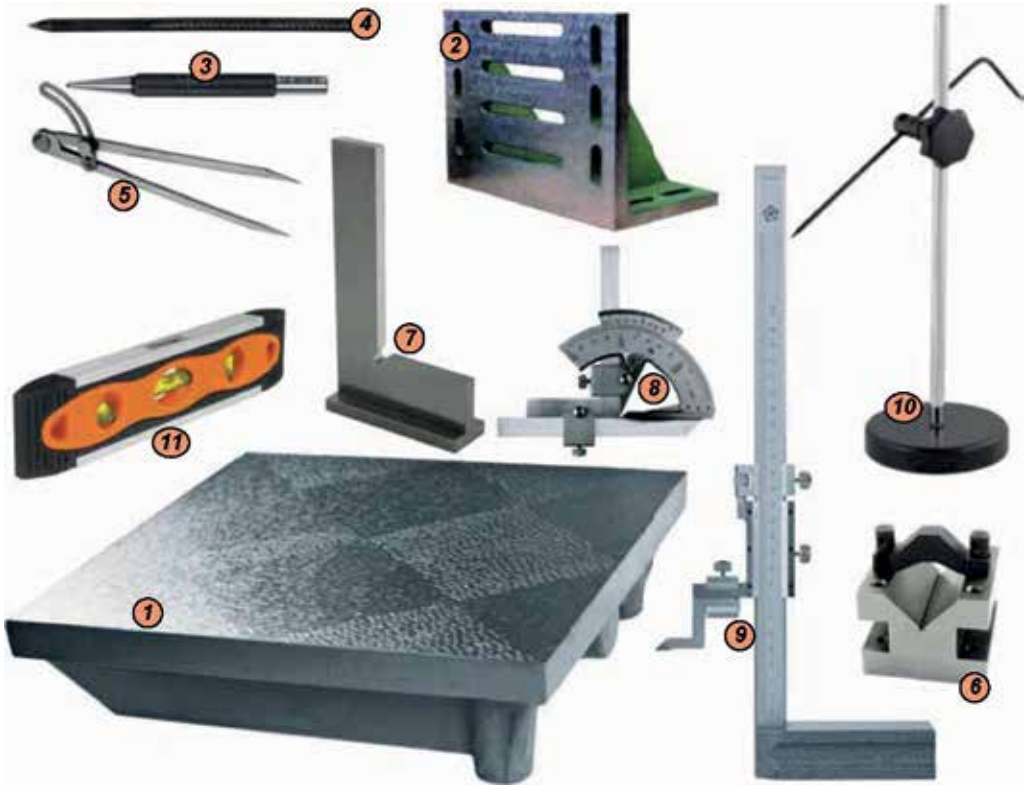
41. ábra. Térbeli bejelölésre használatos szerszámok és eszközök: 1 – jelölőlap; 2 – jelölődoboz; 3 – pontozó; 4 – karcolótű; 5 – körző; 6 – hengertestek rögzítésére szolgáló prizma; 7 – derékszögvonalzó; 8 – szögmérő; 9 – tolokás párhuzamjelölő; 10 – párhuzamjelölő; 11 – vízmérték
