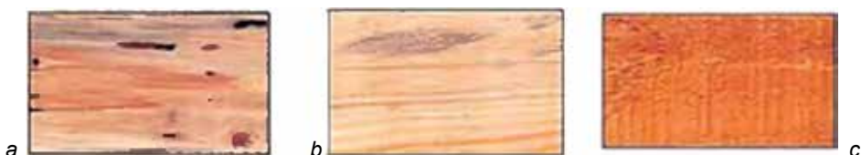
29. ábra. Faanyagok meghibásodásai: a – féregjárat; b – kékülés; c – karc
