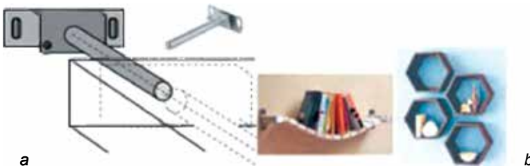
242. ábra. Polcok rögzítése rudas konzollal: a – rögzítés vázlatja; b – rögzített polcok
