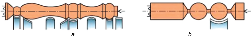
195. ábra. Különböző felületek kialakítása profilkésekkel
