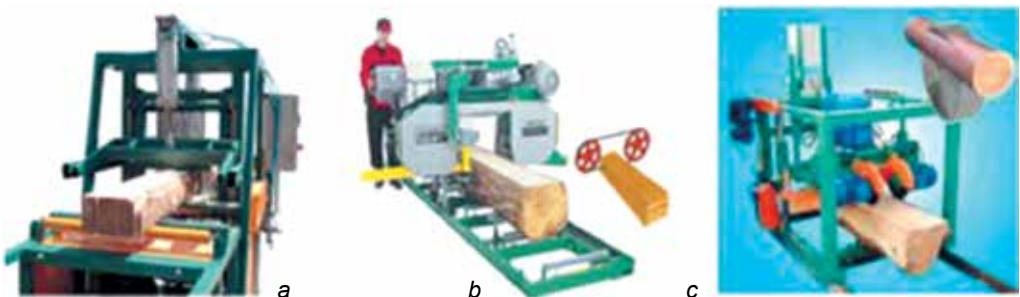
10. ábra. Fűrészgépek: a – függőleges keretfűrész (gatter); b – szalagos; c – korongos
