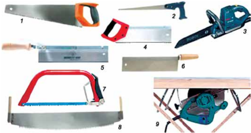
61. ábra. Asztalos fűrészek típusai: 1 – széles lapú kézfűrész; 2 – keskeny lapú (körvágó) kézfűrész; 3 – elektromos láncfűrész; 4 – gérvágó fűrész; 5 – sarus fűrész; 6 – illesztő fűrész; 7 – kerti fűrész; 8 – kétnyelű keresztfűrész; 9 – elektromos tárcsafűrész
