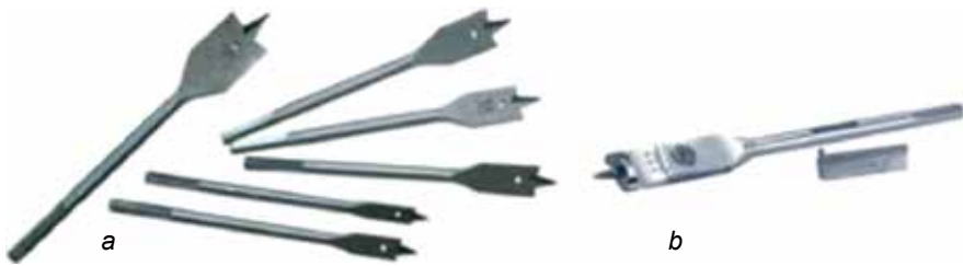
125. ábra. Kanalas fúrók: a – közösleges; b – szabályozható (széthúzzható)
