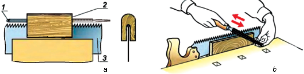
67. ábra. a – fogak magasságának kiegyenlítése (1 – reszelő; 2 – fahasáb; 3 – fűrészlap); b – fogak élézése
