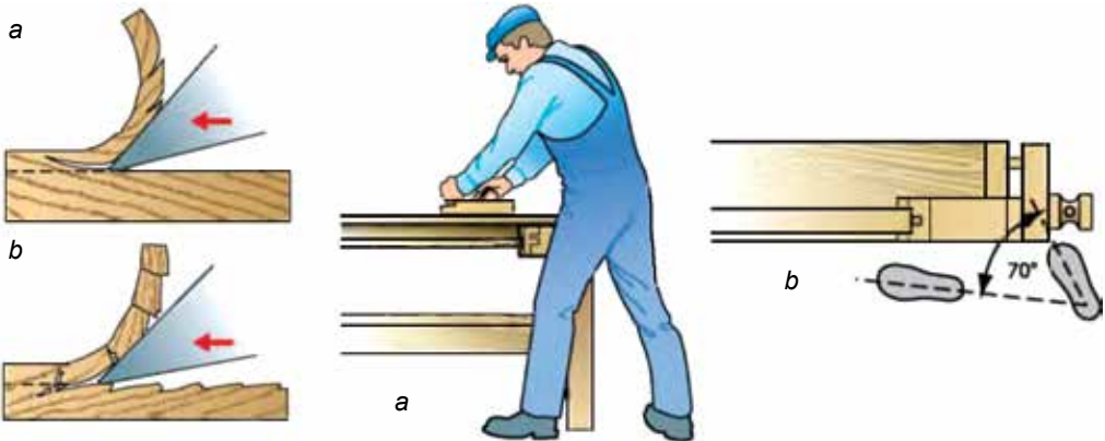
93. ábra. Vágás: a – szálirányban; b – száliránnyal ellentétesen
