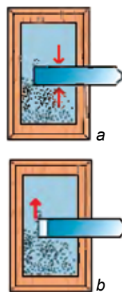
112. ábra. Vágóél kiigazítása
