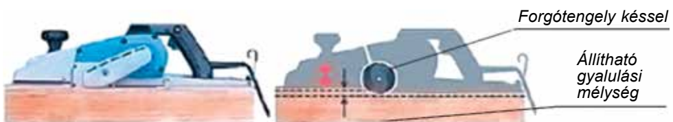
82. ábra. Az elektromechanikus gyalu működési elve
