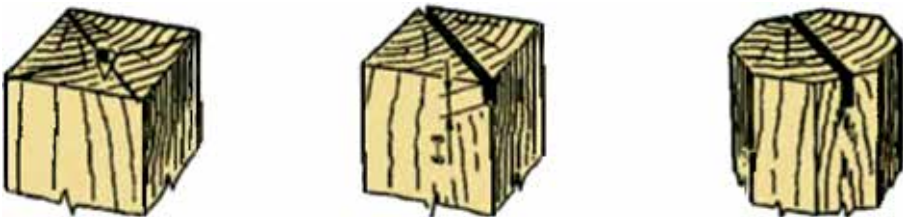
181. ábra. Munkadarab elkészítése háromágú szigonnyal történő rögzítéshez
