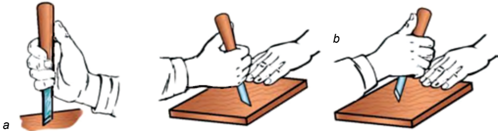
149. ábra. Faragás folyamata: a – vágószerszám helyes fogása; b – vágószerszám helyzete munka közben („feléd”, „tőled”)
