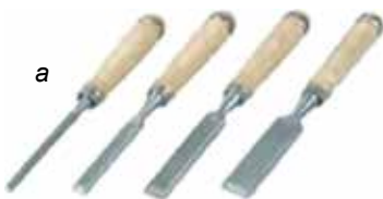
110. ábra. Szerszámkészletek: a – csaplyukvésők; b – laposvésők; c – félköríves vésők
