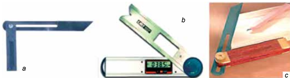
51. ábra. Állítható szögvonalzó:
