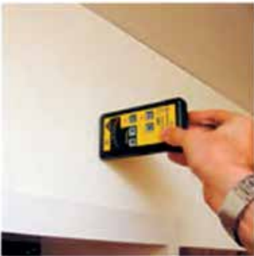
243. ábra. Rejtett elektromos vezetékek helyének felderítése
