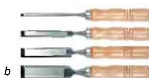
110. ábra. Szerszámkészletek: a – csaplyukvésők; b – laposvésők; c – félköríves vésők
