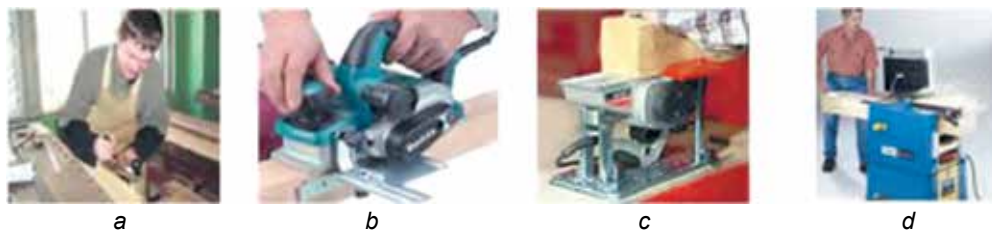
76. ábra. Faanyag gyalulásának módjai: a – kézi gyaluval;
