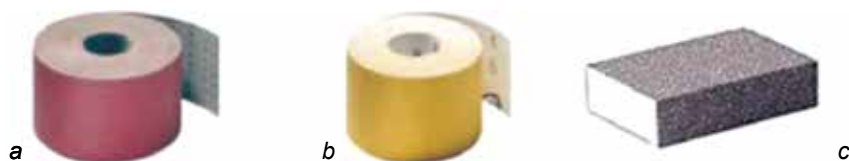
138. ábra. Csiszolóanyagok: a – vászon alapú csiszolópapír; b – papír alapú csiszolópapír; c – habszivacs alapú csiszolóhasáb
