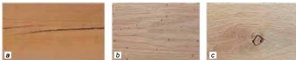
140. ábra. Csiszolási helyek: a – repedések; b – pontszerű elszíneződések; c – görcs
