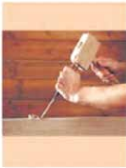
108. ábra. Munkavégzés laposvésővel és csaplyukvésővel
