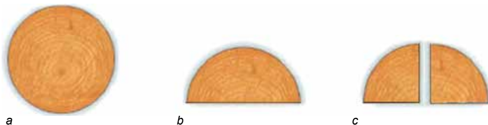
16. ábra. Fűrészárúk: a – rönk; b – félrönk; c – negyedrönk
