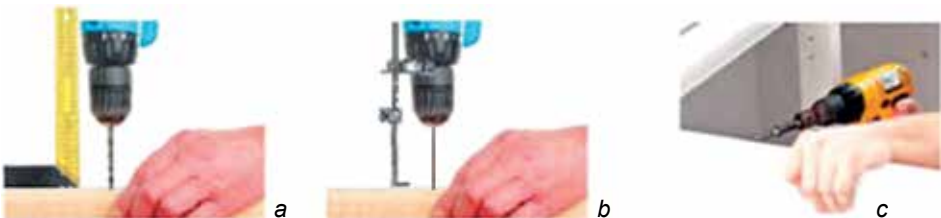
130. ábra. Fúrás villanyfúróval: a – fúrás derékszögének ellenőrzése; b – furat készítése mélységállító felhasználásával; c – csavar behajtása
