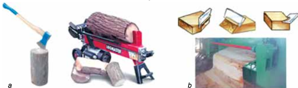
57. ábra. Faanyag vágása anyagréteg leszedése nélkül: a – hasítás; b – furnérra vágás ékeléssel
