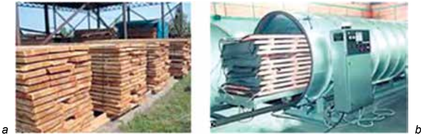
26. ábra. Faanyag szárítása: a – természetes módon; b – elektromos szárítóban
