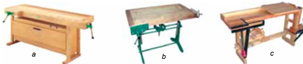
4. ábra. Asztalos munkapadok: a – hagyományos; b – kombinált; c – univerzális
