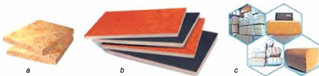
13. ábra. Szerkezeti anyagok: a, b – ragasztóoldatos famasszák; c – fa alapú műanyagok
