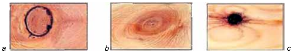
27. ábra. Görcsök: a – száraz; b – egészséges; c – rothadt
