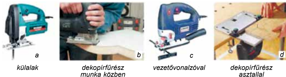
173. ábra. Elektromos dekopírfűrész és használata
