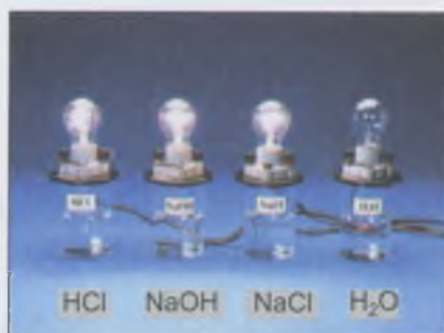
20. ábra Vizes oldatok elektromos áramot vezető képességének kimutatása
