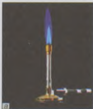
52. ábra A metán égése: a) gázégőben; b) háztartási gáztűzhelyen
