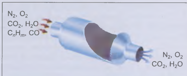
66. ábra Katalizátorral ellátott szűrőbetét keresztmetszete
