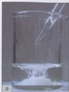
27. ábra Ólom(II)-bromid (a) és ólom(II)-jodid (b) csapadékának kiválása.
