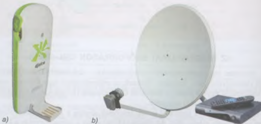
2.8. ábra. A vezetékek nélküli kapcsolódás eszközei: a) vezetékek nélküli modem; b) műholdas antenna
