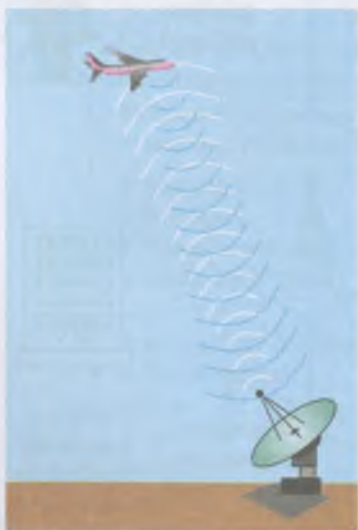
21.2. ábra. A radar működési elve
