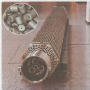
27.1. ábra. Nukleáris fűtőelem – a reaktor része, nukleáris fűtőanyagot tartalmazó berendezés (urán-dioxid tabletták)
