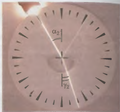
12.3 ábra. A fénytörés törvényeinek bemutatása: a beesési szög csökkenésével ( \alpha_2 < \alpha_1 ) csökken a törési szög is ( \gamma_2 < \gamma_1 ), eközben \frac{\sin \alpha_1}{\sin \gamma_1} = \frac{\sin \alpha_2}{\sin \gamma_2}
