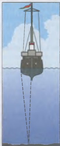
18.9. ábra. Vízmélység mérése echolokáció segítségével
