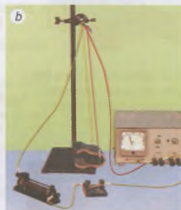
4.1. ábra. A mágneses tér alumíniumból készült áramjárta vezetőre gyakorolt hatásának bemutatása: áram hiányában a mágneses tér nem hat a vezetőre (a); amikor a vezetőben áram folyik, az kilendül egyensúlyi helyzetéből (b)
