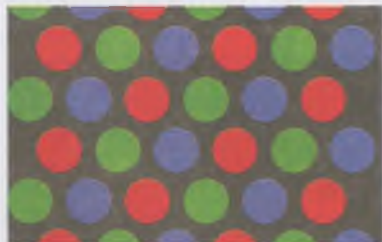
13.4. ábra. Ha kézi nagyítóval nézzük a számítógép monitorját, végtelen számú piros, zöld és kék köröcskét látunk
