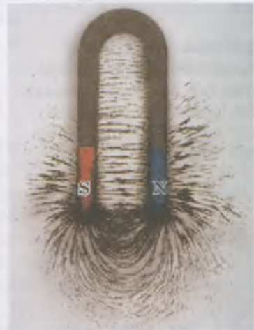
2.4. ábra. A vasreszelék által alkotott kép megmutatja a mágnespatkó mágneses terének indukcióvonalait
