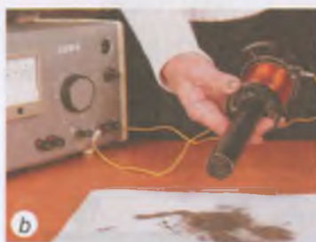
6.4. ábra. Az áramkör zárása után a vasmag magához vonzza a vasreszeléket (a); megszakításakor a vasreszelék lehullik (b)
