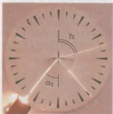
12.5. ábra. Ha a fény az üvegről a levegőbe esik, a beesési szög növekedése során a törési szög megközelíti a 90^\circ -ot, a fényessége pedig csökken
