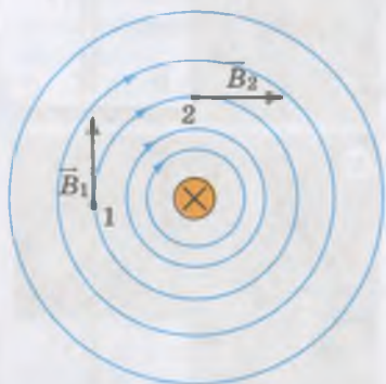
3.3. ábra. Az áramjárta vezető mágneses terének indukcióvonalai. A vezető az ábra síkjára merőlegesen helyezkedik el; a kereszt (x) azt jelenti, hogy az áramerősség a vezetékben tőlünk elfelé mozog
