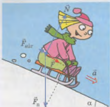
31.1. ábra. Az \vec{F} erő, az \vec{F}_n nehézségi erő, az \vec{N} reakcióerő és az \vec{F}_{sűr} csúszási súrlódási erő eredője. Az \vec{F} erő hozza létre a kislány \vec{a} gyorsulását
