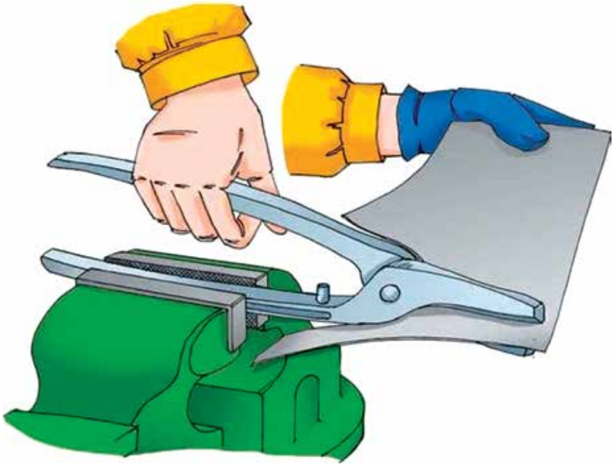
75. ábra. Vágás satuba rögzített ollóval
