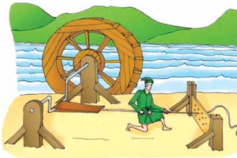
30. ábra. Huzal előállítása vízkerék felhasználásával
