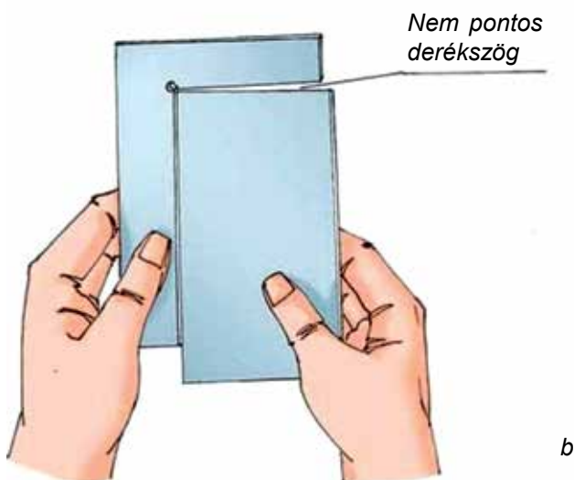
88. ábra. Reszelt felület ellenőrzése egyenes (a) és derékszögű (b) vonalzóval
