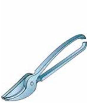
79. ábra. Görbepengéjű lemezvágó olló vékony lemezfém vágásához
