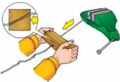
120. ábra. Huzal egyenesítése fahasábban lévő furaton át
