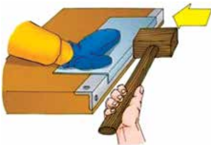
108. ábra. Munkadarab végének behajlítása falcolás előtt
