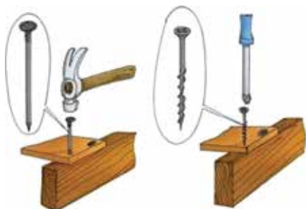
33. ábra. Hidegpréselésre alkalmas huzalból előállított szögek és facsavarok
