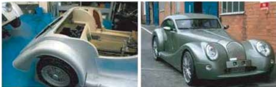
91. ábra. Balról – karosszéria fa váza és fém panelei; jobbról – kész gépkocsi
