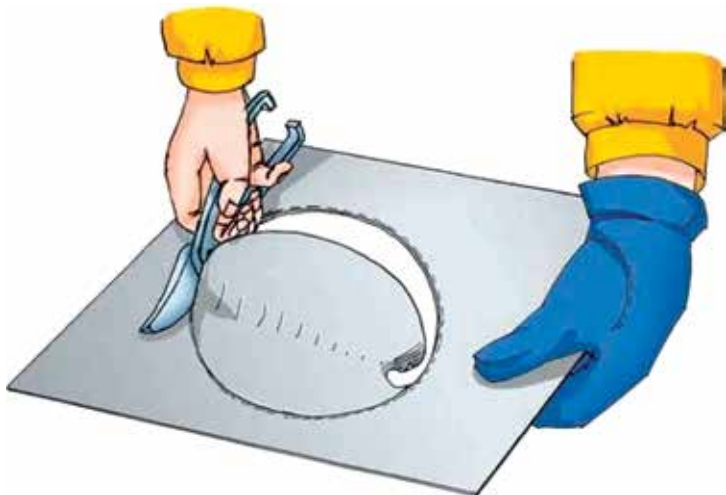
77. ábra. Lyuk vágása görbepengéjű ollóval
