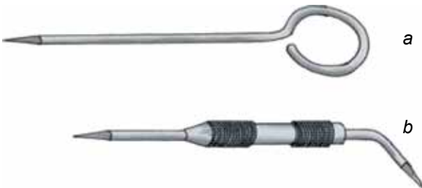
65. ábra. Karcolótű: a – egyenes; b – behajlított végű kombinált
