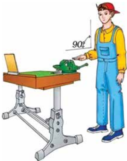
11. ábra. Munkapad megfelelő magassági beállításának ellenőrzése
