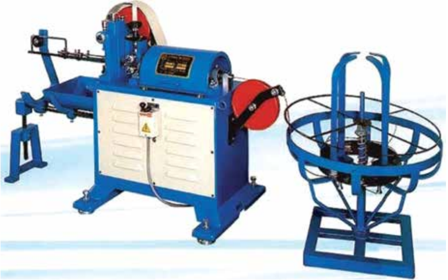
140. ábra. Huzalból készített hajlított elemek előállítására szolgáló speciális gép
