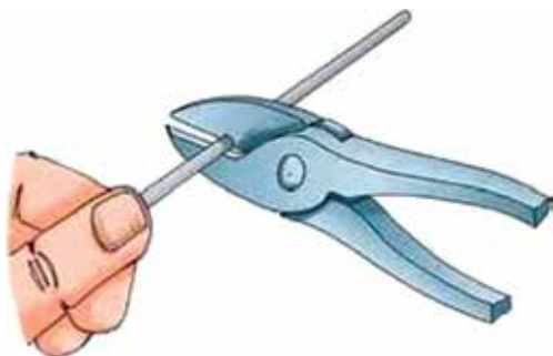
129. ábra. Huzal vágási technikája oldalvágó csípőfogóval
