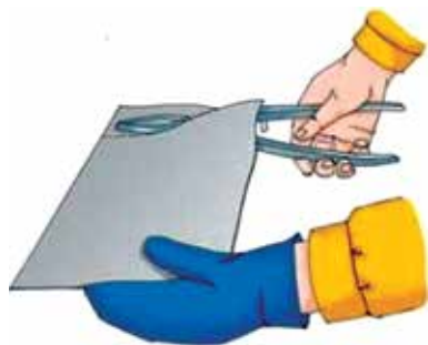
74. ábra. Olló fogása vékony lemezfémm vágásánál
