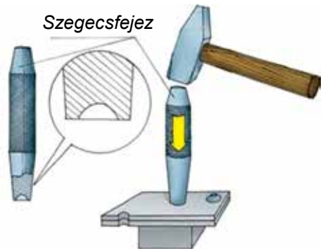
117. ábra. Zárófej végleges kialakítása szegecsfejezővel
