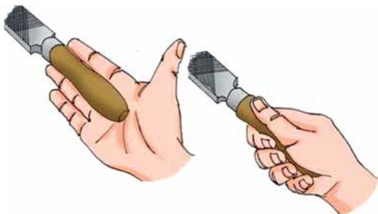
85. ábra. Reszelés. A jobb kéz helyzete a reszelő nyelén
