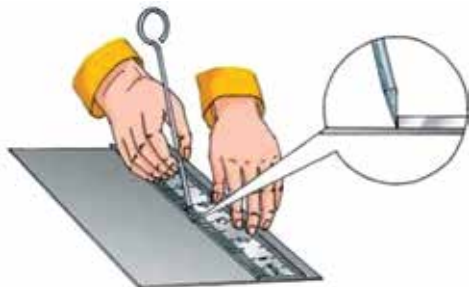
69. ábra. A karcolótűt a vonalzótl a hegyezésnek megfelelő szögben döntik meg
