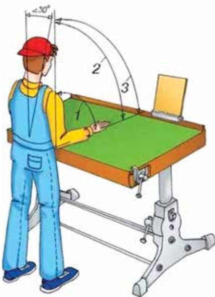
5. ábra. Függőleges síkú munkazóna
