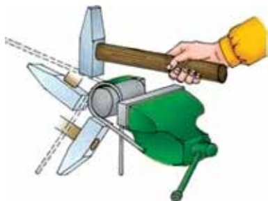
136. ábra. Huzal satuban történő hajlítása sablon segítségével
