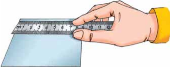
63. ábra. Munkadarab méretének meghatározása léptékvonalzó segítségével
