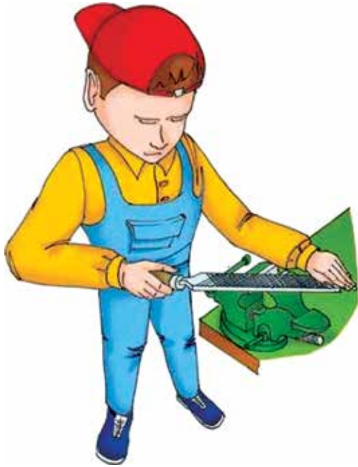
14. ábra. Álló helyzetben történő munkavégzés közbeni helyes kéz- és lábtartás
