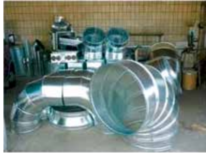
101. ábra. Falcolt varratok felhasználásával készített ipari szellőzőrendszer elemei
