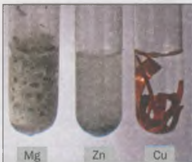
59. ábra. A fémek viselkedése a hígított kénsavoldatban
