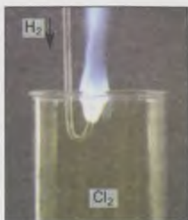
27. ábra. A hidrogén égése a klór atmoszférájában
