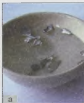
26. ábra. A magnézium viselkedése vízben (fenolftalein indikátor jelenlétében): a) hideg; b) meleg
