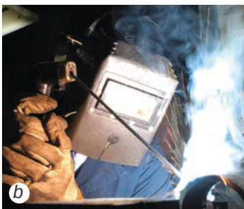
40.10. ábra. Ívkisülés alkalmazása fémek olvasztására (a) és hegesztésére (b)
