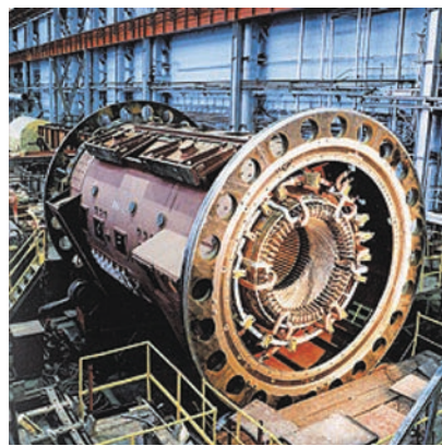
25.2. ábra. A turbinák forgásának mechanikai energiáját elektromos áram energiájává alakító turbógenerátorok állítják elő a világon elfogyasztott villamos energia 80%-át
