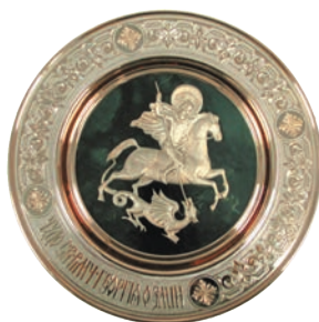
38.4. ábra. Domború másolatok készítése elektrolízis segítségével: a – a berendezés vázlatrajza: a grafitral bevont viaszminta a katód (1), az ezüstlemez az anód (2); a kádban ezüst(I)-nitrát-oldat van; b – a kapott másolat
