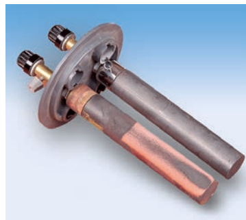
37.5. ábra. Néhány perccel azt követően, hogy áramot bocsátunk át a réz-klorid oldatán, a katód felületét vékony rézréteg lepi be
