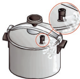
14.5. ábra. Gyorsfőző fazék (kukta): a szelepnek és a hermetikus fedőnek köszönhetően az edény belsejében megmarad a nyomás, ezért a víz forráspontja az ilyen edényben megközelítőleg 120 °C.
