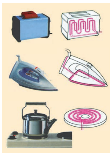
35.2. ábra. Minden elektromos melegítőkészülék fő része a fűtőelem
