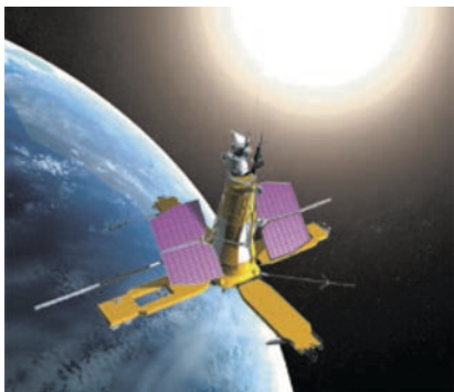
25.3. ábra. A Föld körül keringő műhold napelemei az összes berendezést ellátják elektromos energiával. A napelemek a fényenergiát alakítják át elektromos energiává
