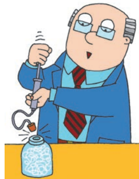
4.5. ábra. A kísérlet, amely azt bizonyítja, hogy miközben a levegő mechanikai munkát végez, a belső energiája csökken. Ennek bizonyítéka az üvegben létrejött köd
