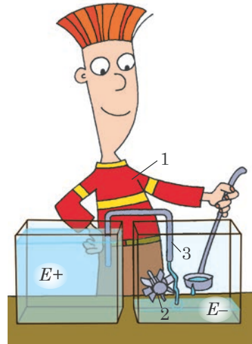
26.4. ábra. A 26.1. ábrán bemutatott elektromos áramkör mechanikus megfelelője. Az egyes elemek az ábrán feltüntetett számok alapján feleltethetők meg
