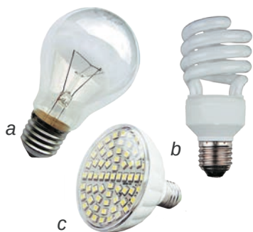
24.3. ábra. Elektromos égők – az elektromos áramot részben fénné alakító berendezések: a – izzólámpa (hatásfoka – 5%); b – energiatakarékos fénycső (hatásfoka – 10–20%); c – fénydiódás (LED) lámpa (hatásfoka – 50%)
