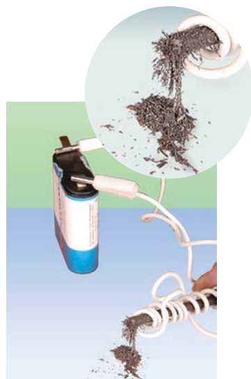
24.5. ábra. Az áram áthaladásakor a vasszeg mágnessé válik, és vonzza a vasreszelék szemcséit
