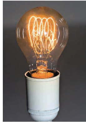
35.3. ábra. Az izzólámpa fűtőszálát wolfram-ból készítik, melynek az olvadáspontja 3387 °C. Miután elérte a 3000 °C hőmérsékletet, a vékony wolframszál fényesen világítani kezd
