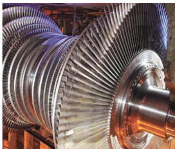
17.3. ábra. A modern turbinákban a gőz energiájának maximális kihasználása érdekében több, ugyanarra a tengelyre rögzített, lapátokkal ellátott keréket használnak
