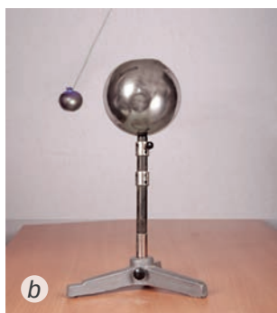
21.3. ábra. Gömb elektromos megosztása (a); a töltés kimutatására a pozitív töltéssel rendelkező gömböcske szolgál, amely elhajlik a gömbtől, tehát a fémgömb (a rúdtól eltérően) pozitív töltéssel rendelkezik (b)
