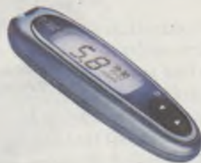
24. ábra. Glükométer: a vércukorszint mérésére szolgáló eszköz
