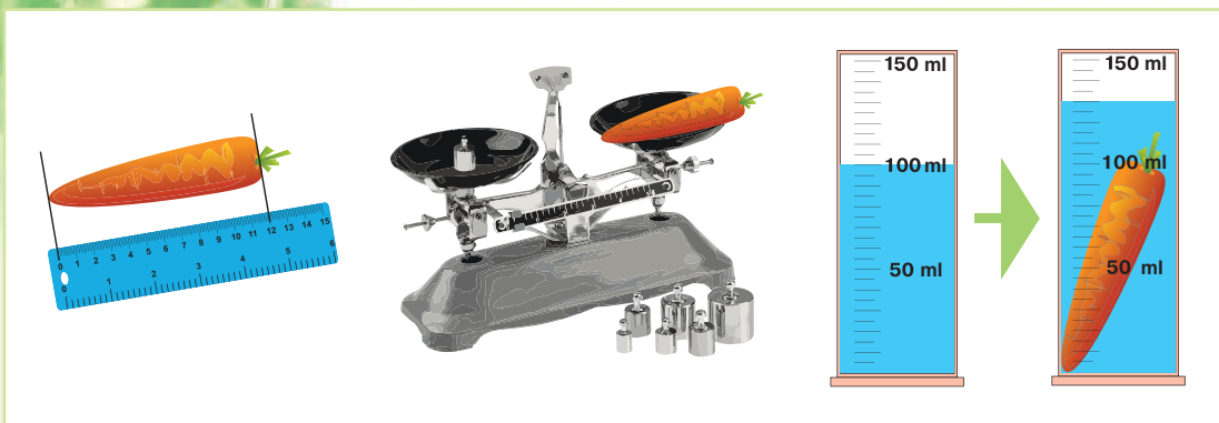
10. ábra. Szabálytalan alakú test méreteinek, tömegének és térfogatának meghatározása
