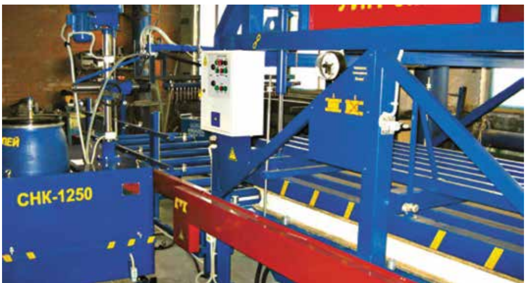
29. ábra. Furnérgyártó automata gépsor
