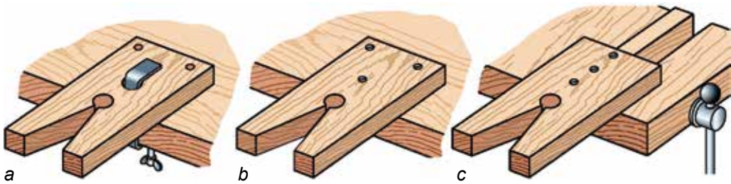
57. ábra. A fűrészasztal rögzítése a vágáshoz: a – csavaros szorítóval; b – facsavarokkal; c – satuval
