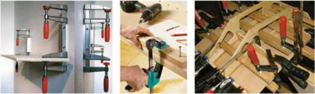
106. ábra. Összeragasztott elemek tömörítése csavaros szorítókkal
