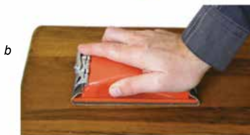
84. ábra. A csiszolópapír rögzítése: a – fahasábon; b – csiszolószerkezeten
