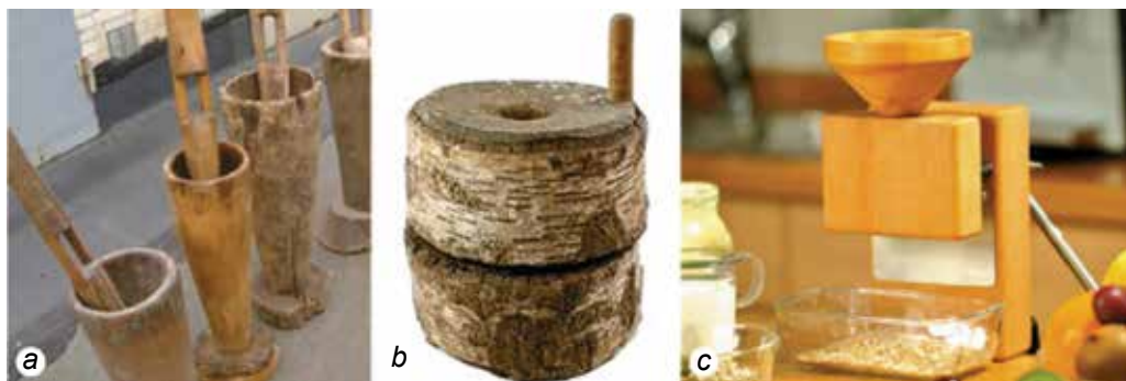
192. ábra. Dara készítésére szolgáló eszközök: a – famozsár; b – kézi daratörető; c – modern elektromos daratörető
