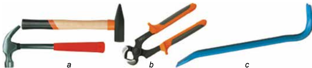
110. ábra. Szerkezeti elemek egymáshoz szögelésekor használt fő szerszámok:
