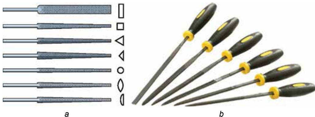
92. Türeszelőtípusok: a – sematikus ábrázolás; b – külalak
