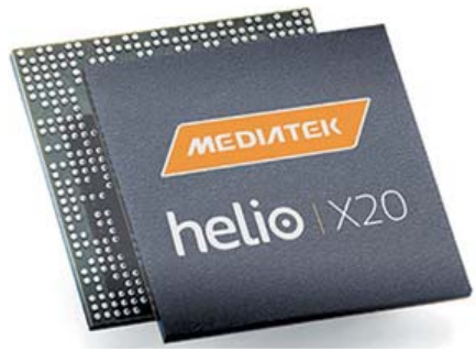
2.2. ábra. Tízmagos Helio X20 processzor
